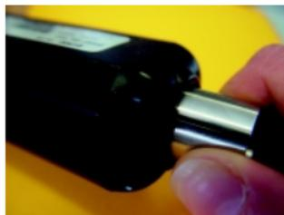
Sujetar fuertemente el cambiador de filtros, desatornillar girando en sentido contrario a las agujas del reloj y retirar el filtro. Si hay agua en la carcasa (al otro lado
