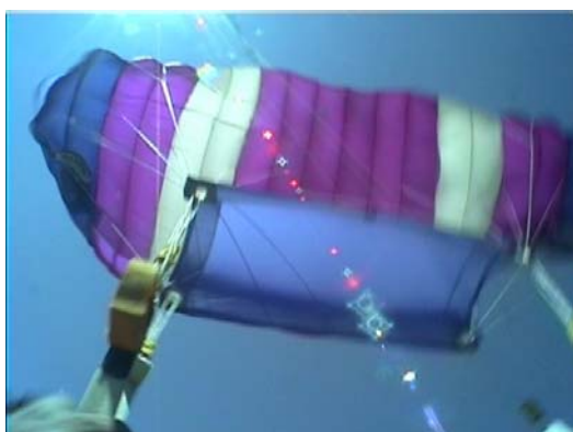
Celdas exteriores cerradas (fig51)
